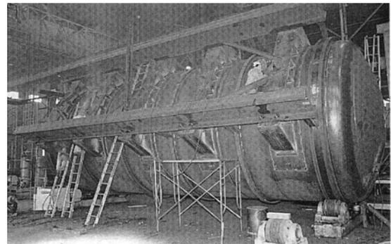
原子力発電所 補助エンジン地下燃料タンク製作
